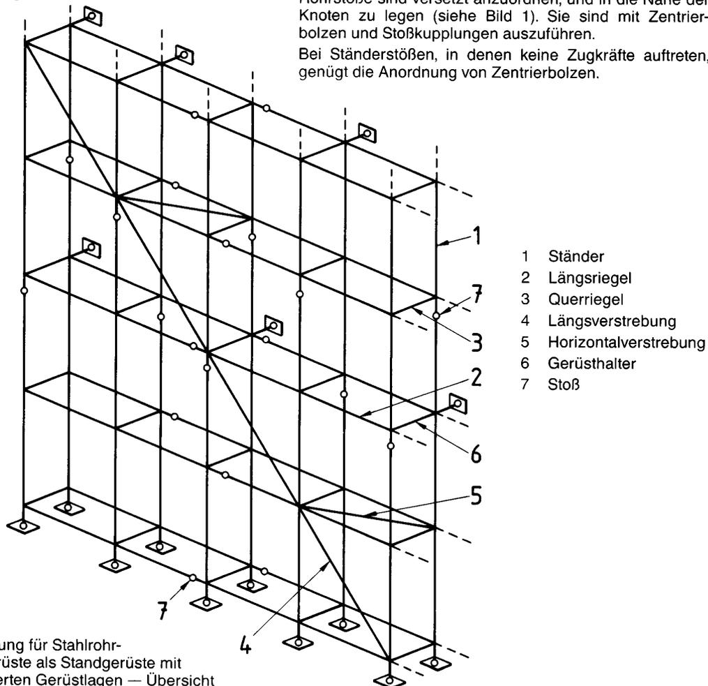
Bild 1. Regelausführung für Stahlrohr-Kupplungsgerüste als Standgerüste mit längenorientierten Gerüstlagen — Übersicht
